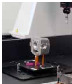
K551218: Alsó vevő raklaprendszer alkalmazása
